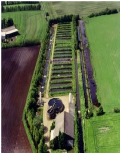
Figur 14. Kongeåens modeldambrug type 3. Produktionsenhederne omfatter 3 sektioner, der hver består af 2 beton raceways med mikrosigter (maskestørrelse 74 µm) foran biofilter sektionerne (forgrunden). I baggrunden til venstre ses plantelagunerne bestående af de tidligere jorddamme og indløbs- og udløbskanaler (Svendsen et al., 2008). Foto: Lars M. Svendsen.
